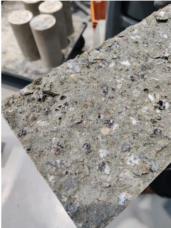
Kuva 2. Betonin rakenne. Kuva Saara Leppä.
