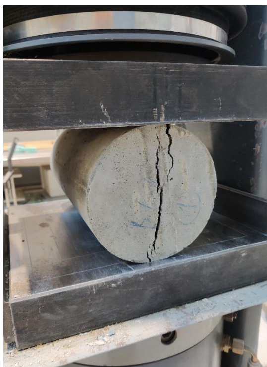
Kuva 11. Vetolujuuden mittaus. Kuva Saara Leppä.
