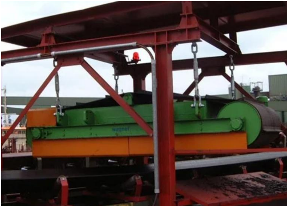
Kuva 15. Sähkömagneettierotin hihnalla (Wagner Magnete, kuva: Enerec).
