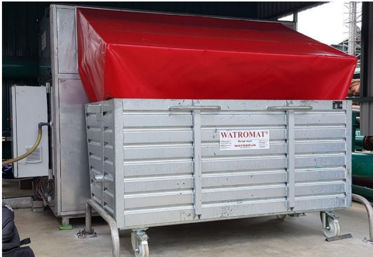
Kuva 21. Terminen kuivain 30 °C (Skip-dryer, kuva: WATROPUR Oy)
