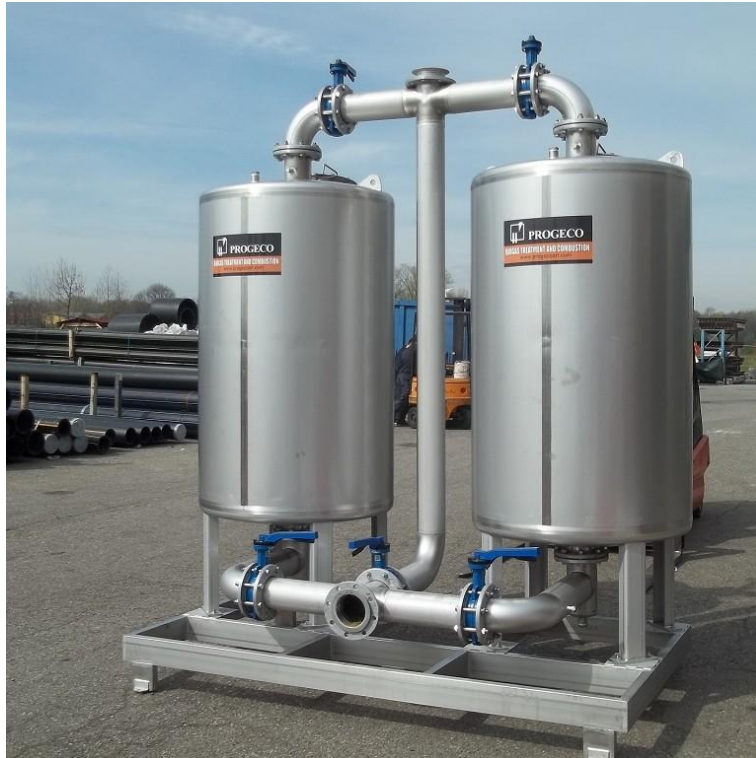
Kuva 23. Aktiivihiihisuodatus biokaasun jalostukseen (Progeco, kuva: Conveco Srl)
