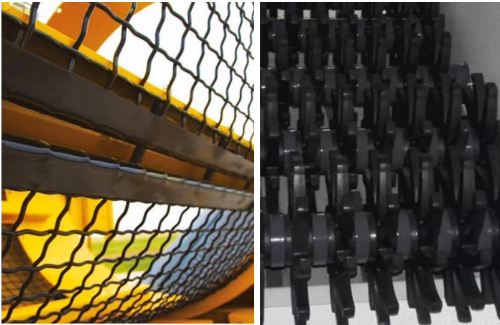
Kuva 14. Vasemmalle rumpuseula (Vermeer TR6400, kuva: Several Oy) ja oikealla tähtiseula (Vecoplan, kuva: Innomac Oy).
